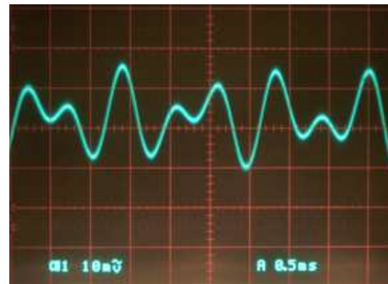
本キットの 1kHz / 1.6kHz ツートーン波形
