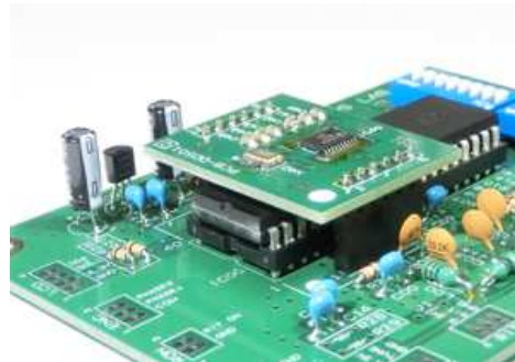
6pin ソケットを使って DDS UNIT を取付ける
