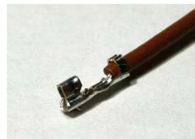
エンジニアの精密圧着ペンチでコンタクトを圧着する
